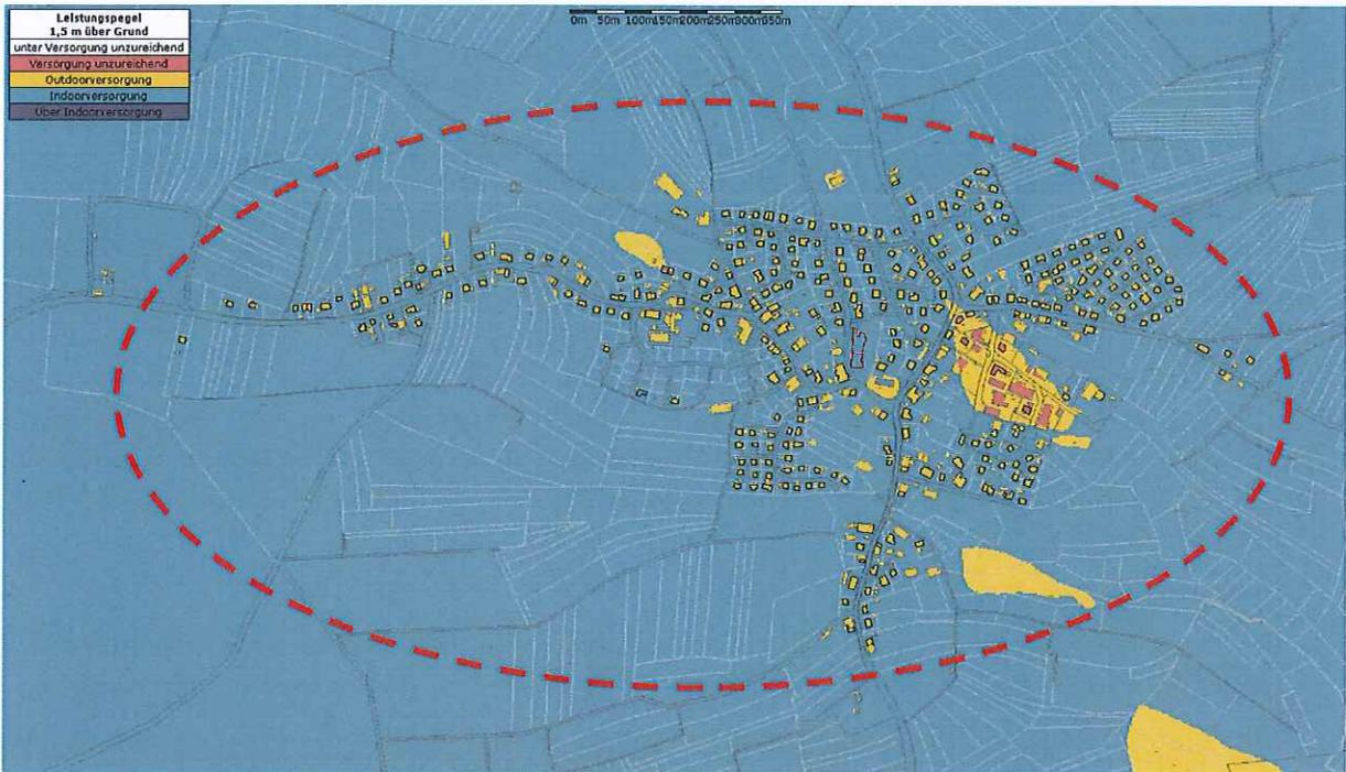
Abb. 12: Funkversorgung mit Erhöhung des Masts in Königsfeld – Ausschnitt Neuhausen
