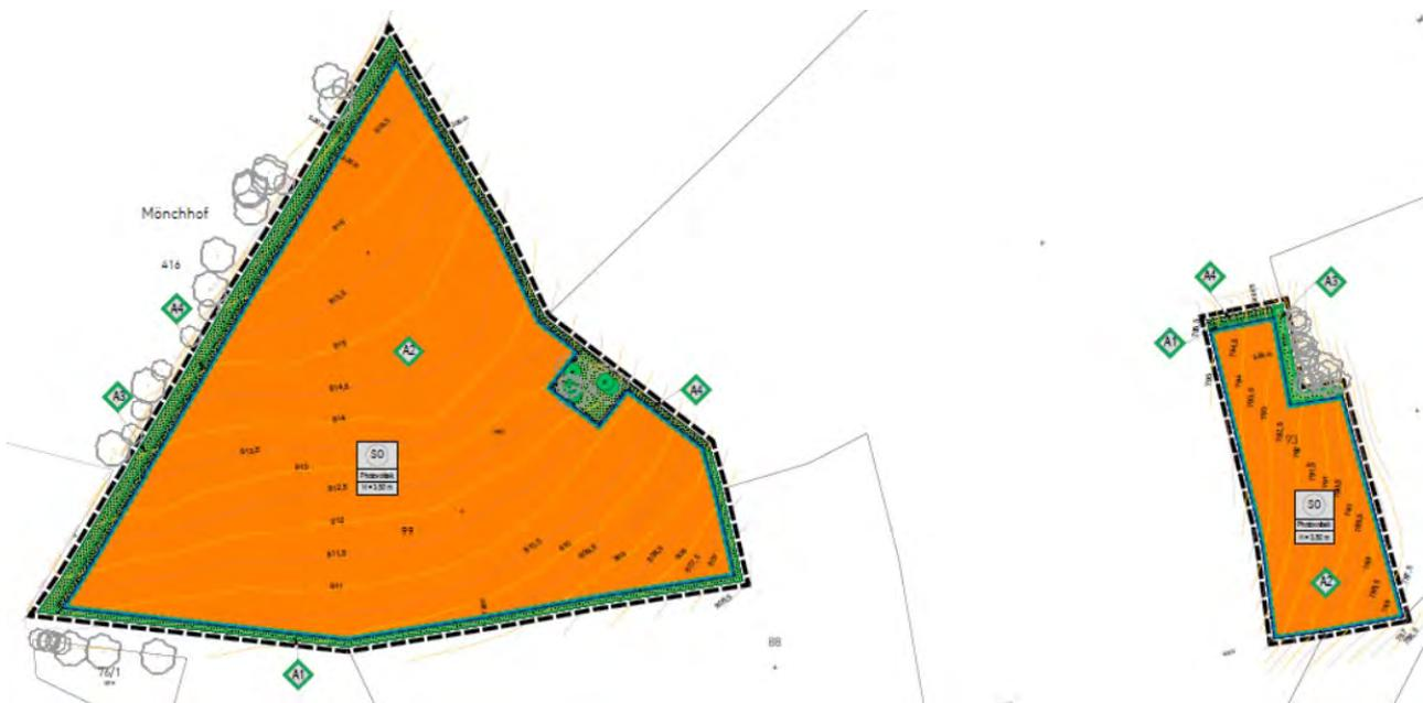
Abb. 1: Ausschnitt aus dem Bebauungsplan: Gebietsteile der Photovoltaik-Anlage: orange: Fläche für Solarmodule bei gleichzeitiger landwirtschaftlicher Nutzung; grün: Flächen der festgesetzten Grünordnungsmaßnahmen
